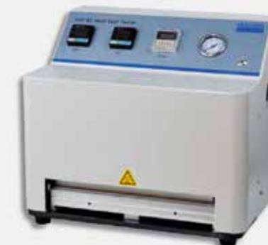
Determina los parámetros de sello caliente de la muestra, como películas básicas, películas compuestas, papel de revestimiento y otros tipos de materiales. Los parámetros incluyen la temperatura, la duración y la presión de sellado. Personalización de la mandíbula de sellado disponible.
