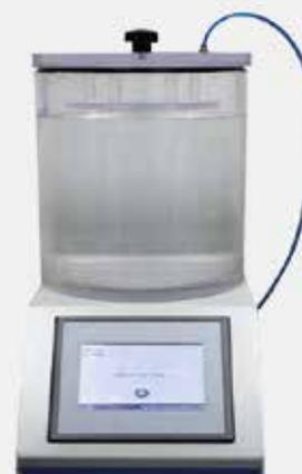
El Medidor de Hermeticidad LSD-01A es un equipo empleado para medir el sellado de envases Pouches, botellas de plásticos, tubos, pipas, botellas de aluminio y otros envases para el envasado en la industria de alimentos, farmacéuticos, médicos, químico, automotriz, componentes eléctricos y otras industrias.
