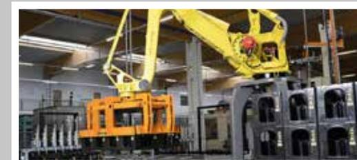
Paletizador antropomorfo, programable, con funciones parecidas a las de un brazo humano. Permiten tanto un movimiento rotacional, como un movimiento traslacional o desplazamiento lineal.
