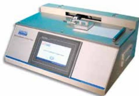
El medidor de coeficiente de fricción es aplicable en pruebas de fricción estáticas y kinestáticas en películas de plástico, bolsas de tejido de PP, telas, cintas, etc. Con la prueba de suavidad del material el usuario puede controlar y ajustar los índices de calidad deseable en la prueba para cada requerimiento. También se aplica para la medición de suavidad de algunos productos químicos.
